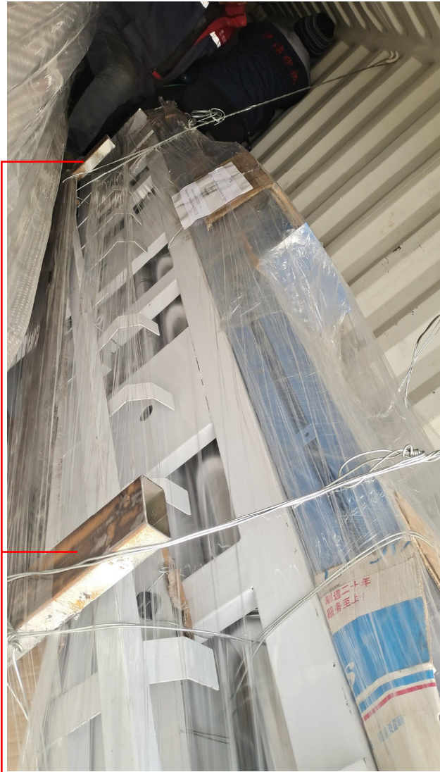
Estos no son parte de la maquina, es solo un soporte para evitar que los modulos se muevan
